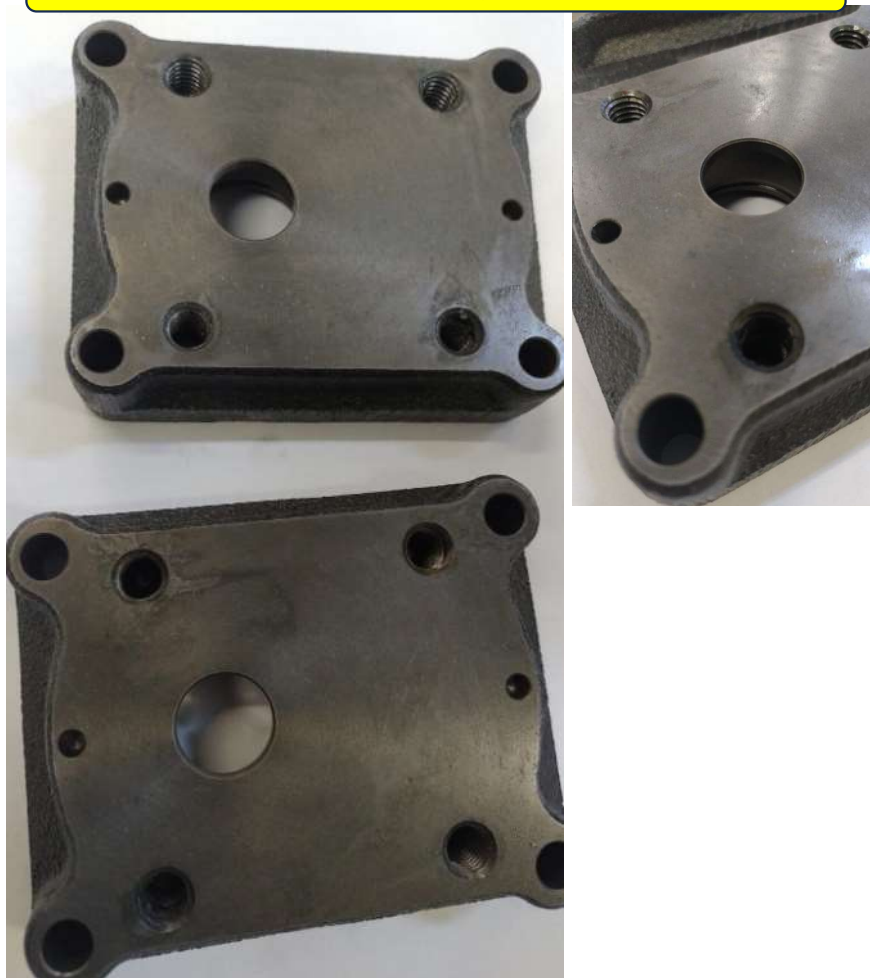
Oxido e sujeira furos não passantes 17/10/24
